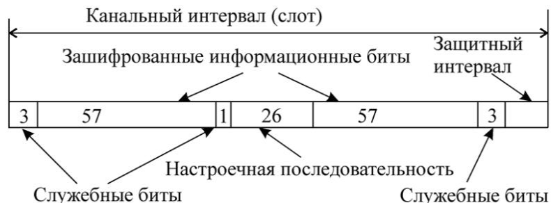
Рисунок 9.4. Структура канального интервала стандарта GSM
